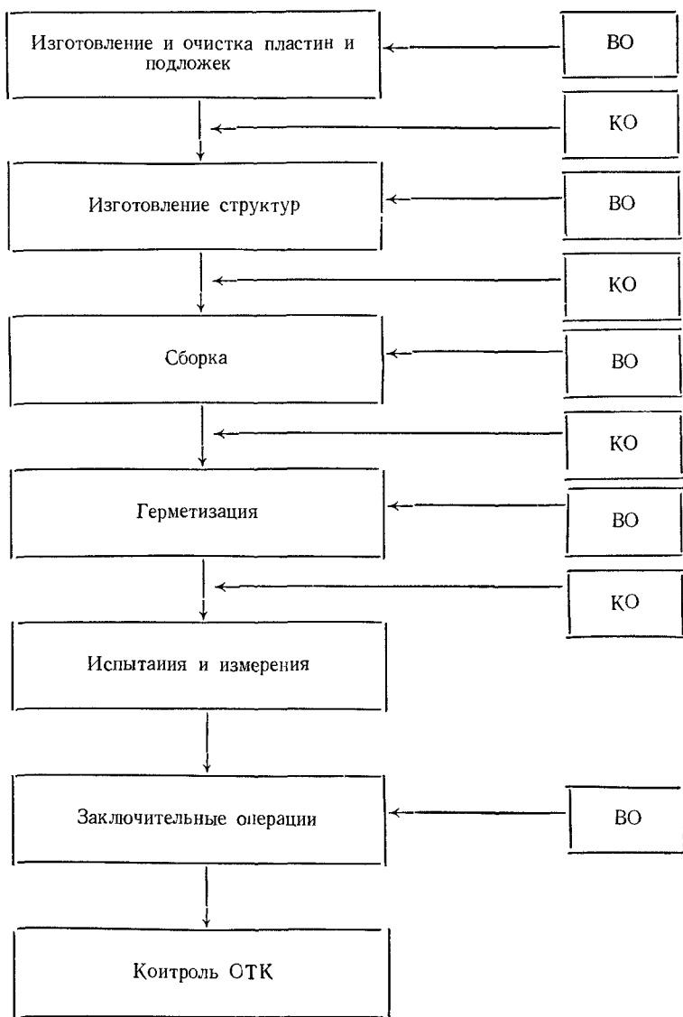
Рис. 25. Общая схема изготовления интегральных микросхем: ВО — вспомогательные операции, КО — контрольные операции
